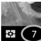
液晶モニター右下の数字はバッファ残量を示しています。連続して撮影できる最大枚数が表示されます。(連続撮影可能枚数が9枚を超える場合は9から変化しません。)
