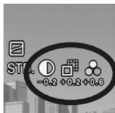
パラメーターを調整すると、画面左側に調整中のパラメーターアイコンと調整量が表示されます。
