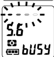
画像データを処理している状態 (ビジー状態) では、シャッター速度表示部が図のようにアニメーションし、カウンターに **「BUSY」** と表示されます。
