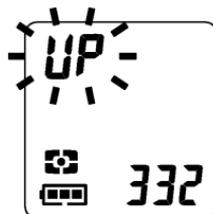
シャッターボタンを半押ししてピントと露出を合わせます。さらに押し込むとミラーが上がりピントと露出が記憶されます (UPの文字が、露出表示と交互に表示されます)。シャッターボタンから指を離してもう1度シャッターを押すと露光され撮影が完了します。
