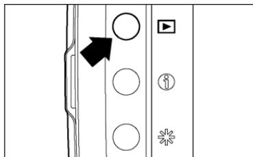
SD15 で撮影した画像を再生するには、本体背面の
