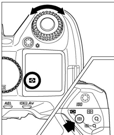
被写体の状況に合わせ、4 つの測光方式を選びます。
