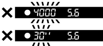
明るすぎたり暗すぎた場合、シャッター速度表示が点滅して警告します。明るすぎる場合は絞り込み（数字を大きく）、暗すぎる場合は絞りを開けて（数字を小さく）、点滅が消えるように調整してください。
