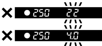
明るすぎたり暗すぎた場合、絞り表示が点滅して警告します。明るすぎる場合はシャッター速度を速くし、暗すぎる場合はシャッター速度を遅くして、点滅が消えるように調整してください。
