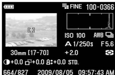
このヒストグラムは、画素の分布が明るい方向にかたより、右端に多くの画素が存在しています。従って露出オーバーで全体に明るめ画像であることを示しています。一般に、右側にかたよっているヒストグラムは、上記のように露出がオーバーしている場合か、もしくは適正露出でも明るい部分や明るめの被写体が画面に占める割合が大きく、明るい画素で構成された画像の場合です。
