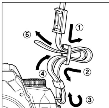
付属のストラップの両端を一旦ほどいて、ファインダーキャップを通してから、図のように左右の吊金具を通して取り付けます。
