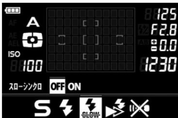
**P / A** モード時のフラッシュ撮影では、シャッター速度が手ぶれを起こしにくいシャッター速度に制限されますが、スローシンクロモードに設定すると、明るさに応じて 30 秒までのスローシャッターで制御されます。夜景と人物の両方に露出の合った写真を撮ることができます。
