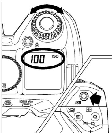
ISO ボタンを押しながら、C ダイアルを回して希望の ISO 感度をセットします。
