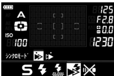
スローシンクロで、動いている被写体を撮影すると、通常は被写体の軌跡が動く被写体の前方に写し込まれます。これは、シャッター幕が全開したときにフラッシュが発光するため、フラッシュ発光後～シャッター幕が閉じるまでの軌跡が写し込まれるためです(先幕シンクロ)。後幕シンクロモードを使用すると、シャッター幕が全開した後、閉じるときにフラッシュが発光するため、シャッター幕全開～フラッシュ発光までの軌跡が、動く被写体の後方に写し込まれ、自然な動きが表現できます。
