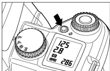
暗い場所で表示パネルが見つからない場合、表示パネル照明ボタンを押すことにより、約 6 秒間表示パネルがオレンジ色に照明されます。
