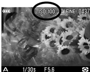
フィルムカメラで、用途に合わせて感度の違うフィルムを選ぶように、撮影時の感度を選択することができます。(ISO 感度 P.103)
