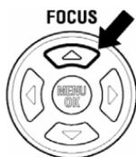
通常のオートフォーカスモード（マーク表示）では、ピントの合う範囲が無制限から 50cm ですが、FULL モードに切り替えると、近距離側のピント範囲を 30cm まで拡大することができます。 **FOCUS** ボタンを 1 回押して FULL モード（マークなしの状態）に切り替えてください。
